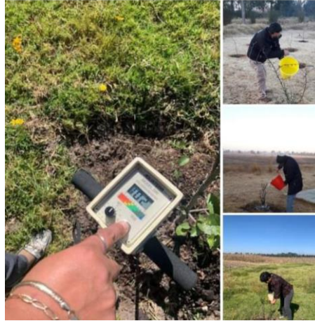
Trabajos de medición de humedad ICAR.
