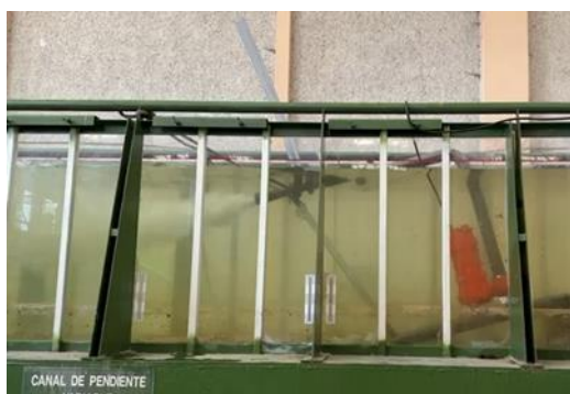
Figura 6.1 Equipo “Aireador-difusor tipo Venturi” instalado en laboratorio como demostración.
