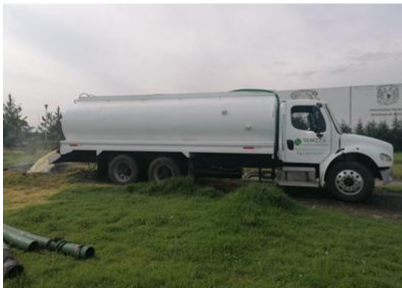
Figura 15. Pipa de aguas residuales terminando de descargar en la PTAR-IITCA
