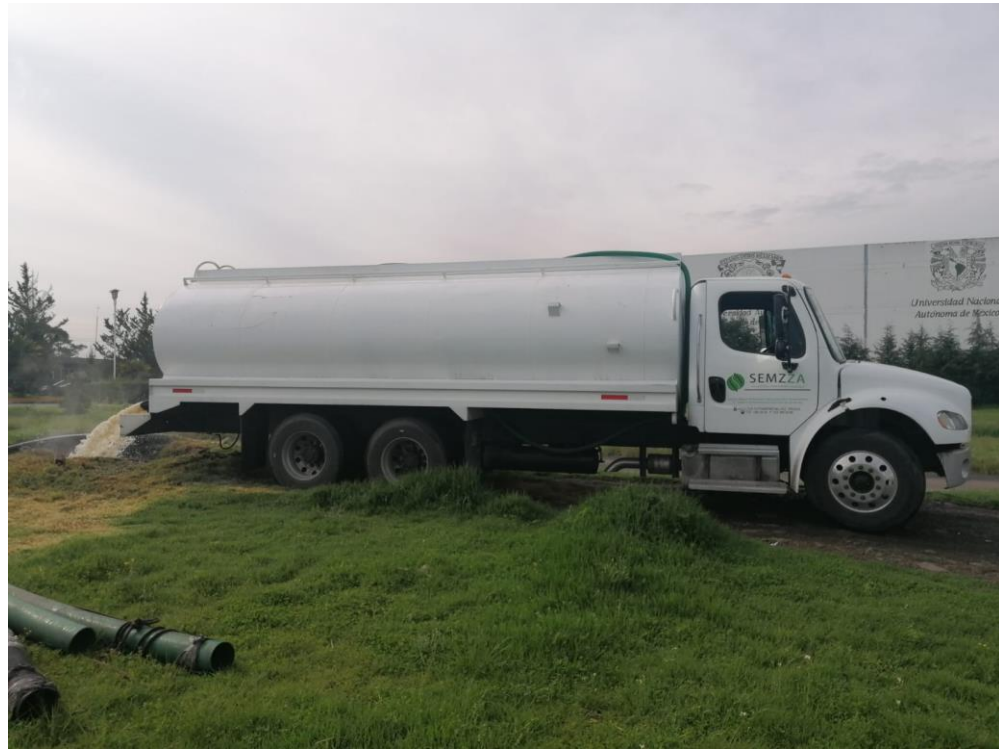
Figura 14.1 Pipa de aguas residuales terminando de descargar en la PTAR-IITCA
